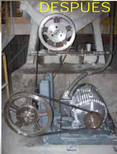
Un importante fabricante de materiales para la construcción estaba en un problema. Tenían un equipo obsoleto con una caja de engranes con una relación de 7:1. Necesitaban una solución.
